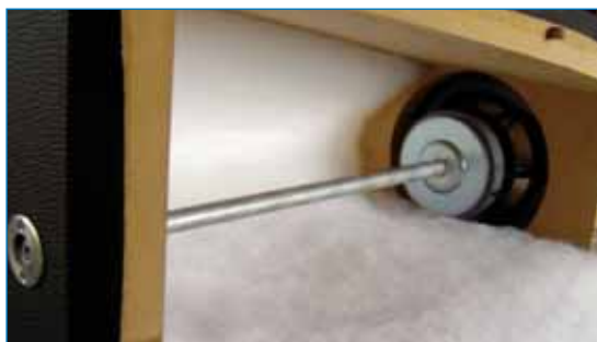
Particolare della barra amagnetica di bloccaggio del midrange che scivola, ad opera di un giunto sferico, nella parte più sorda del cabinet.
